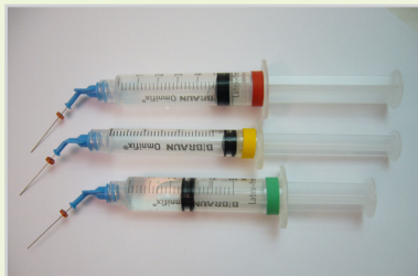
Einmalspritzen mit Farbmarkierungen zur Unterscheidung der Spüllösungen.
